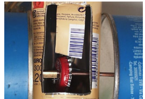
RASENMÄHER MIT MOTOR Spraydosen, Gaskartuschen, PET, Draht Flaschendeckel als Zahnradmotor fixiert mit einer Leuchterklemme
