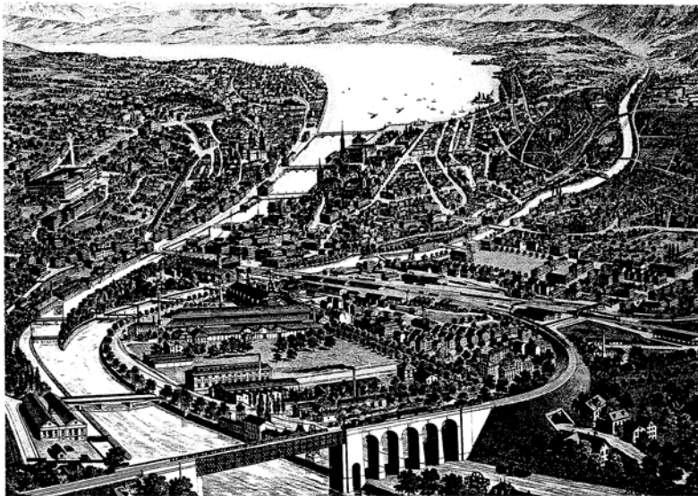
Das Industriequartier 1883 mit Industriegeleise und Seiltransmission. Vom Dach des Wasserwerks laufen Drahtseile über vier Masten zu den Fabriken am Sihlquai. Links der Mitte die Hallen der Schweizerischen Landesausstellung von 1883. Im Vordergrund der massive Bahndamm der Oerlikoner Linie, der in einer Linkskurve zum Hauptbahnhof führte (heutige Röntgenstrasse). (Zeichnung E. F. Graf 1883, BAZ)
