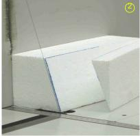
MASCHINENNAME: THERMO-CUTTER VERWENDUNG: STYROPOR; STYROFOAM
